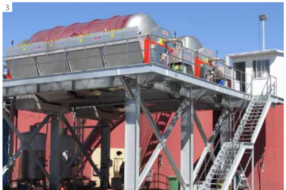
1,3 Installation de presses pneumatiques à tank ouvert, Chili - 2 Open tank loading/unloading hatches 1,3 Impianto presse pneumatiche tank aperto, Cile - 2 Porte de chargement/déchargement tank ouvert 1,3 Instalación de prensas neumáticas de depósito abierto, Chile - 2 Puerta de carga/descarga depósito abierto
