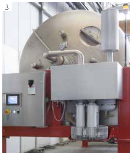
1 Pneumatic press system, USA - 2 Detail of drainage channel - 3 Detail of blower - 4 Touch screen - 5 Sliding gate valve 1 Installation de presseurs pneumatiques, États-Unis - 2 Détail de l'égouttage - 3 Détail de la soufflante - 4 Écran tactile - 5 Vanne à guillotine 1 Instalación de prensas neumáticas, USA - 2 Detalle salida de escurrimiento - 3 Detalle soplante - 4 Panel de pantalla táctil - 5 Válvula de guillotina
