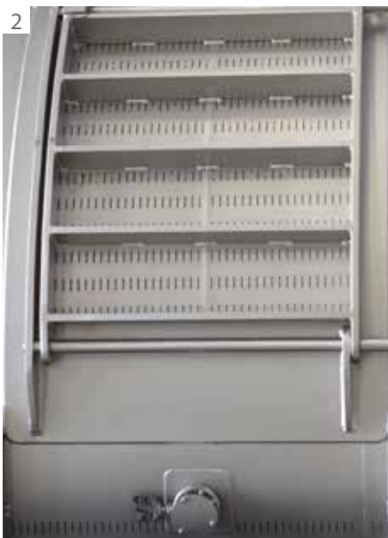
1,3 Installation de presses pneumatiques à tank ouvert, Chili - 2 Open tank loading/unloading hatches 1,3 Impianto presse pneumatiche tank aperto, Cile - 2 Porte de chargement/déchargement tank ouvert 1,3 Instalación de prensas neumáticas de depósito abierto, Chile - 2 Puerta de carga/descarga depósito abierto
