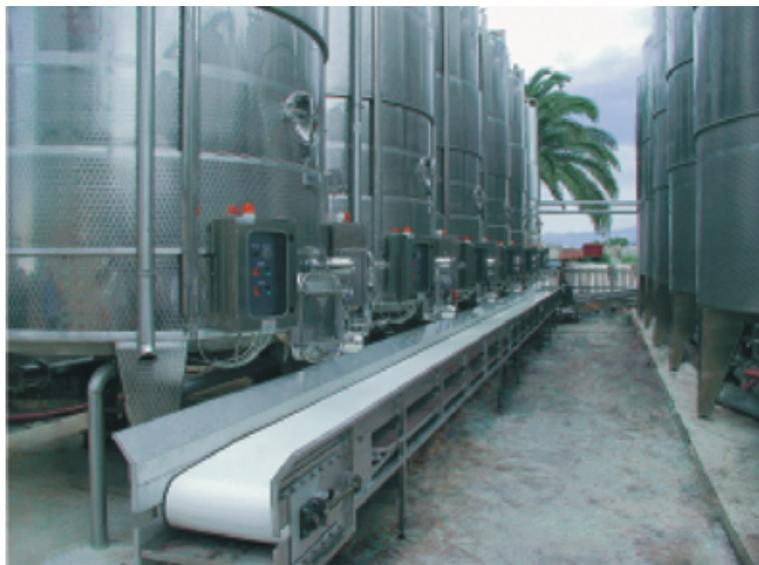
**N**astri per il convogliamento dell'uva e l'evacuazione dei raspi. Sono costruiti interamente in acciaio inox e hanno il tappeto in gomma alimentare. Il tappeto può essere piano, con listelli semplici o listelli con spondaflex: possono essere regolabili in altezza e sono completi di tramogge per facilitarne il carico. Manutenzione e pulizia risultano particolarmente semplici e veloci.
